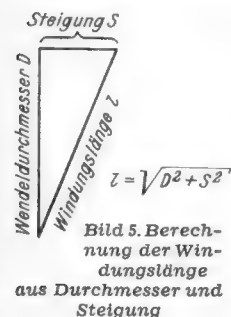
Bild 5. Berechnung der Windungslänge aus Durchmesser und Steigung
